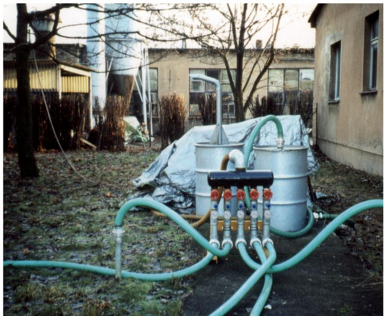
Abb. 5.2-6 Bodenluftabsauganlage
